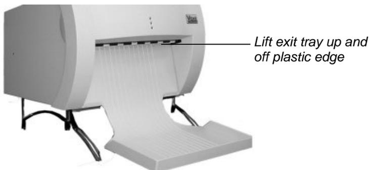
*Removing DiagnosticPRO<sup>®</sup> Advantage and DosimetryPRO<sup>®</sup> Advantage exit tray*
